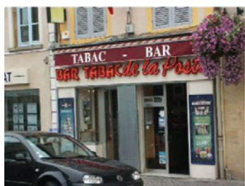
Contre-exemple de devanture en feuillure (la devanture n'est pas correctement mise en retrait par rapport au nu de la façade)
